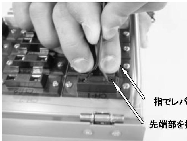
(2) ターミナルレバーを指で押し下げて、振動デバイスケーブルの先端部をターミナルに挿入します。
